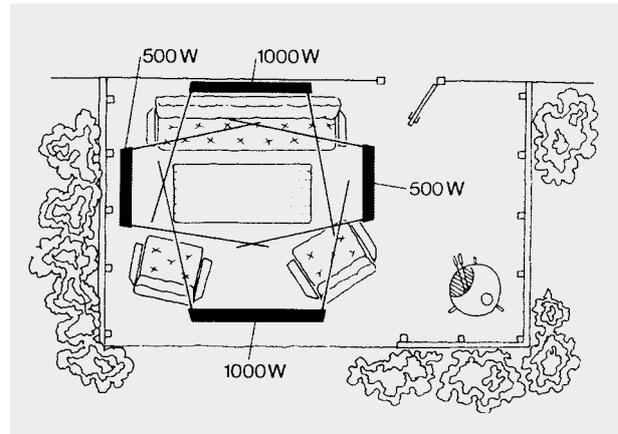
Типичный пример расположения приборов. Комфорт обеспечивается при тепловом потоке равном примерно 1000 Вт/м<sup>2</sup>.
